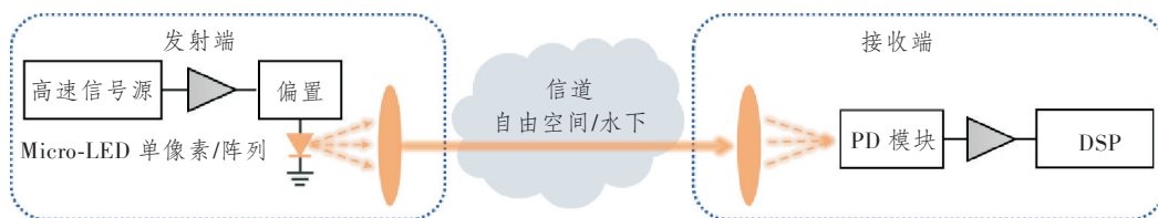
图 1 基于 Micro-LED 的 VLC 系统示意图
